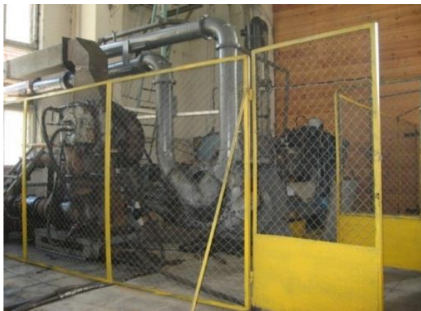
Рис. 1. Стенд для испытания турбокомпрессора и приводного центробежного нагнетателя
