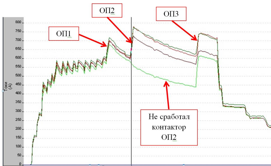
Рисунок 8 – Отказ системы ослабления поля (не сработал контактор)
