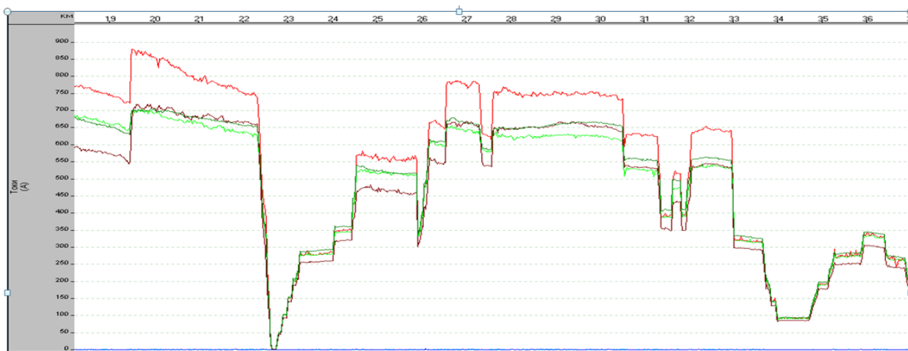
Рисунок 7 – Разброс токов ТЭД (предотказное состояние)
