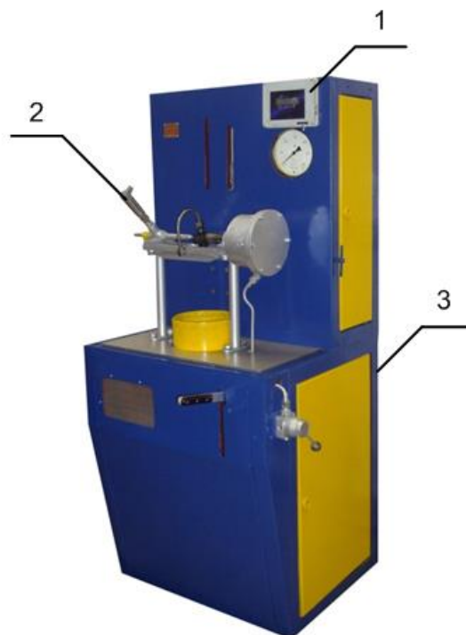
Рис.1. Опрессовочный стенд типа А106 (а) и модернизированный стенд с указанием дополнительно установленного оборудования (б): 1 – блок индикации, сбора, обработки и передачи данных; 2 – тензоэлектрический датчик давления топлива в трубопроводе высокого давления стенда; 3 – датчик линейного перемещения хода плунжера насоса стенда.
