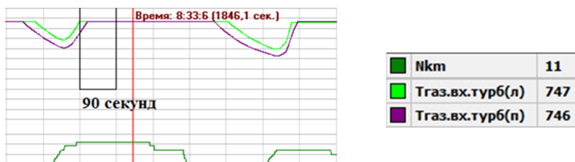
Рисунок 6 – Расшифровка данных с МСУ: неисправна топливная система (температура выхлопных газов недопустима высокая)
