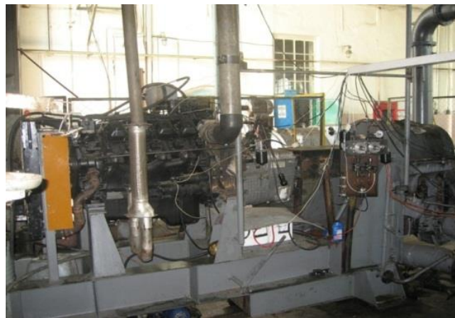
Рис. 1. Стенд для испытания турбокомпрессора и приводного центробежного нагнетателя
