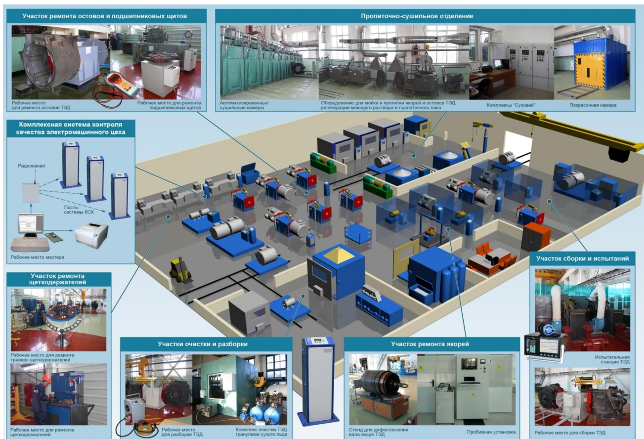
Рисунок 3 – Комплексное оснащение электромашинного цеха
