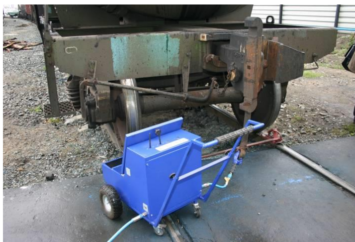
Рисунок 8 – Система проверки тормоза вагона «СПТ-Вагон»
