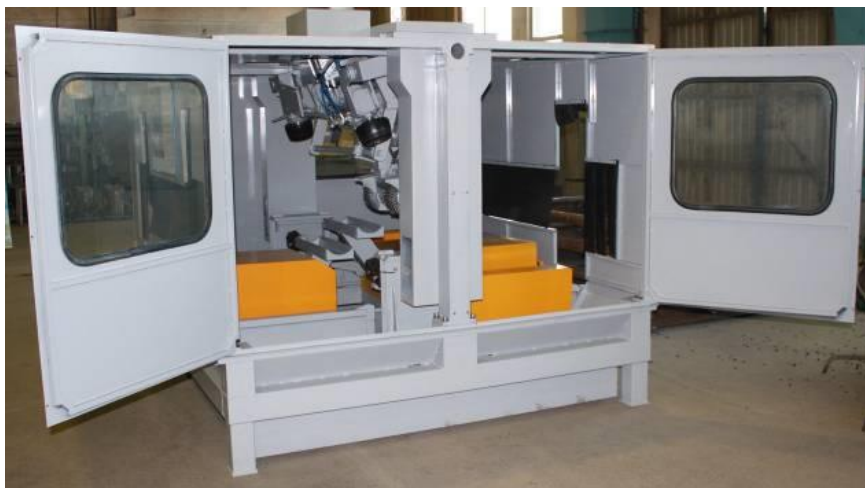
Рисунок 7 – Механизированное рабочее место для механической зачистки средней части и центров оси колесной пары
