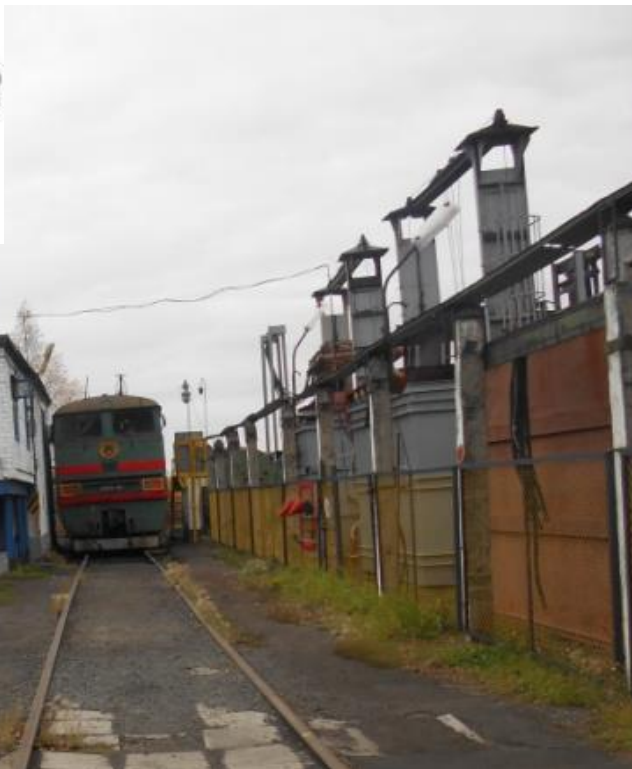
Станция реостатных испытаний тепловозов
